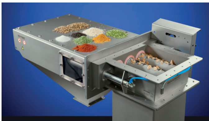
Магнит Cleanflow • Статический , для хорошо текущих порошков • Размер DN200-DN45 • Самотечный, автоматическая очистка • Для пищевых и непищевых применений • Отделение от 30 мкм до прикл. 8 мм.
