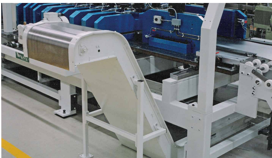
Przenośnik ślizgowy zamontowany pod maszyną tłoczącą do odprowadzania złomu.
