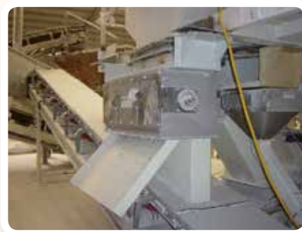
Bubnový separátor s axiálním polem 3 000 gauss při použití v keramickém průmyslu
