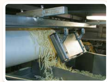
Deskové magnety pro odstraňování feromagnetických částic při výrobě bramborových hranolků
