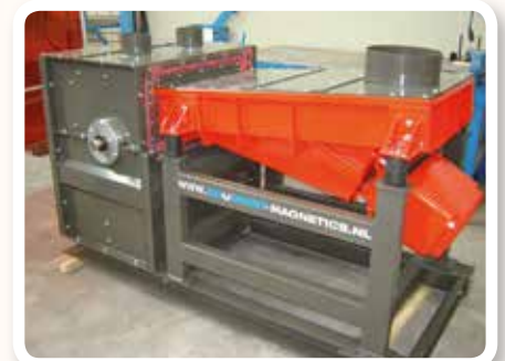
Bubnový separátor zcela zakrytovaný v prachotěsné skříni s magnetickým polem 6 000 gauss vhodný pro keramický průmysl
