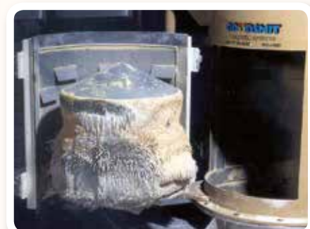
Trubkový magnet odstraňuje velmi jemné Fe částice v keramickém průmyslu
