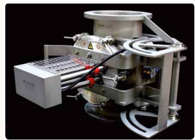
Filtr pro odstraňování vázacích drátků a dalších nežádoucích feromagnetických částic z papírové drtě.
