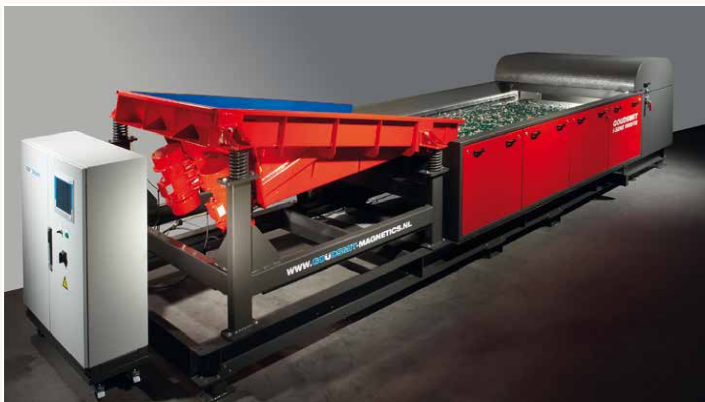
I-Sens separátor o šířce pásu 1500 mm s vibračním podavačem a kontrolní jednotkou
