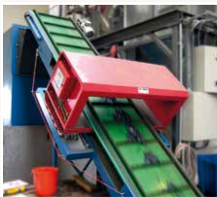
Detektor kovů instalovaný do pásového dopravníku při recyklaci plastů
