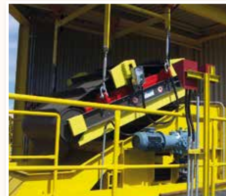
Elektromagnetický závěsný separátor pro dřevozpracující průmysl
