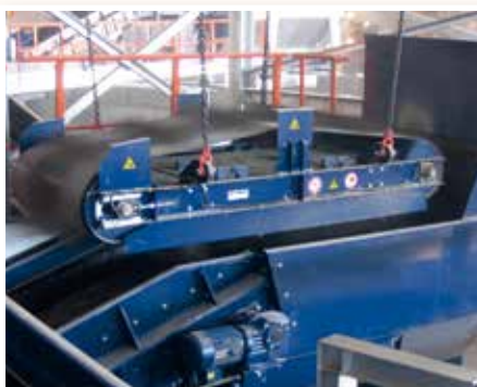
Permanentní závěsný separátor zavěšený podélně nad dopravním pásem
