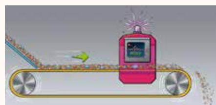
Vysokogradientní magnetický separátor 1500, dvouступňová verze pro recyklaci plastů
