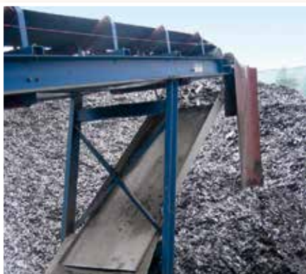
Separace železných částic z drčeného hliníku
