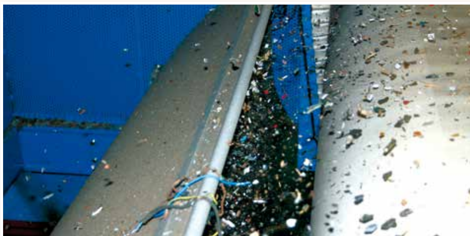
Detail separátoru neželezných kovů (šířka 1500 mm) při třídění WEEE odpadu
