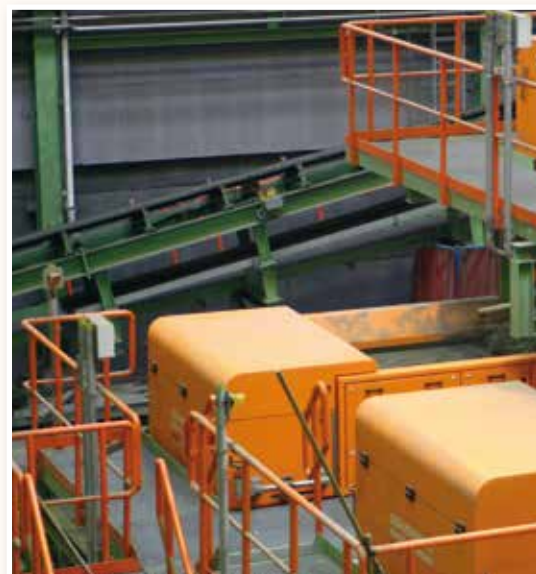
Tři separátory neželezných kovů typ NF1500 při recyklaci strusky ve spalovně
