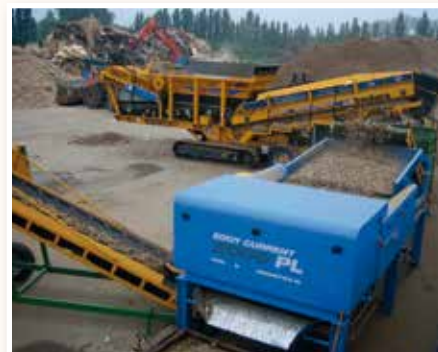
Separátor neželezných kovů se šířkou pásu 2000 mm při úpravě dřevěného odpadu
