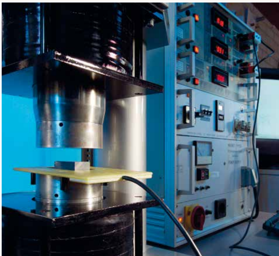
Měřicí systém Permagraph stanovuje magnetické charakteristiky
