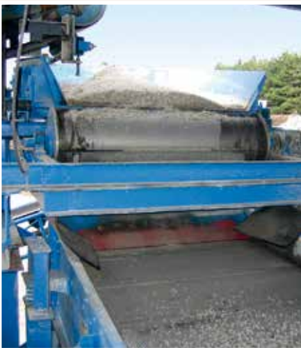
Bubnový separátor s magnety NEOFLUX® pro sklářský průmysl
