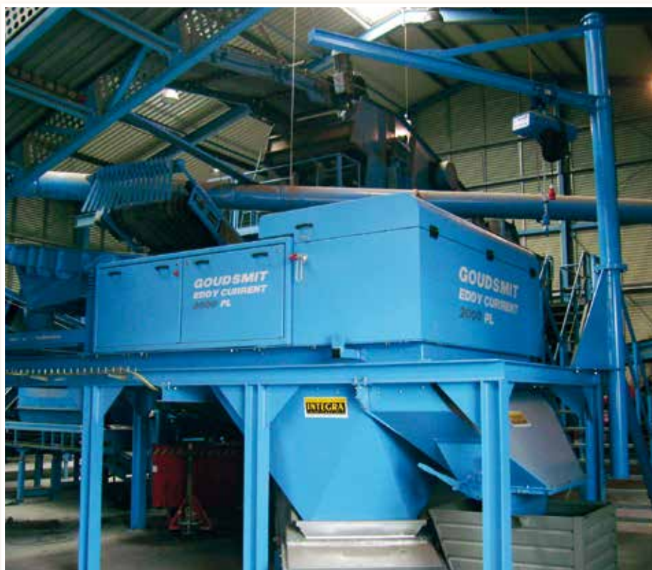
Separátor neželezných kovů typ NF2000 při úpravě strusky ve spalovně
