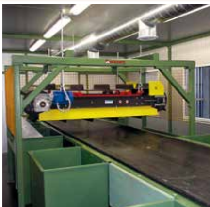
Permanentní závěsný separátor umístěný napříč nad třídícím pásem
