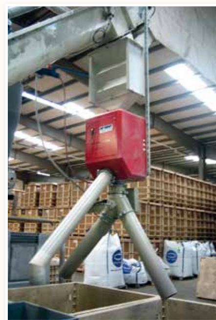
Potrubní detektor kovů pro recyklaci přístrojových desek
