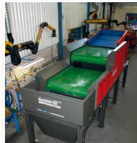
Vysokogradientní magnetický separátor 1500, dvouступňová verze pro recyklaci plastů
