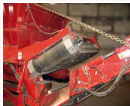
Závěsný separátor NEOFLUX® instalovaný na drtiči dřeva (lehký a kompaktní)
