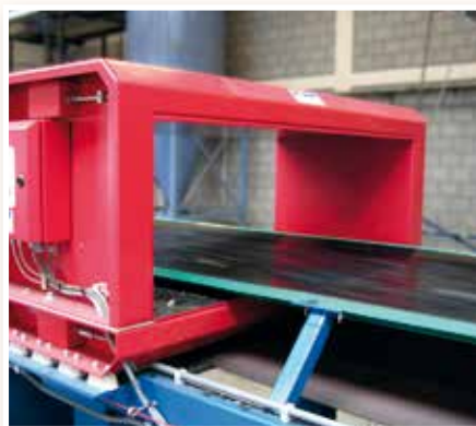
Instalace detektoru kovů s jasně viditelnou „nulovou nekovovou zónou“
