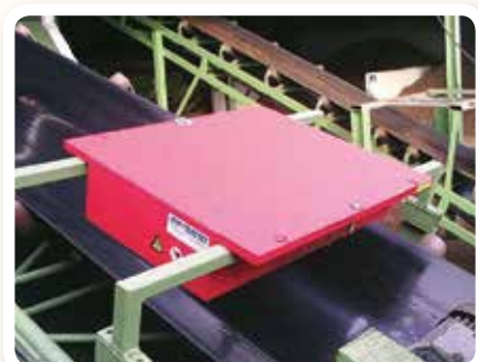
Nadaśmowa ferrytowa płyta magnetyczna do usuwania cząsteczek magnetycznych z ziemi ogrodowej.
