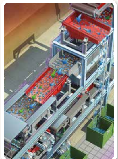
Systemy magnetyczne stosowane w recyklingu metali i odpadów.
