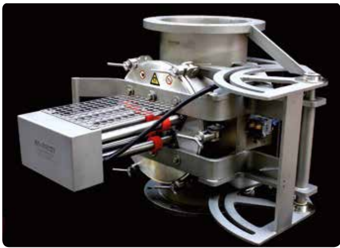
Automatyczny filtr magnetyczny stosowany przy koncentratkach soków owocowych.
