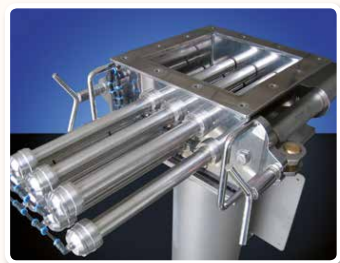
Separator Clean-Flow w wykonaniu higienicznym zgodnym z wytycznymi EHEDG.
