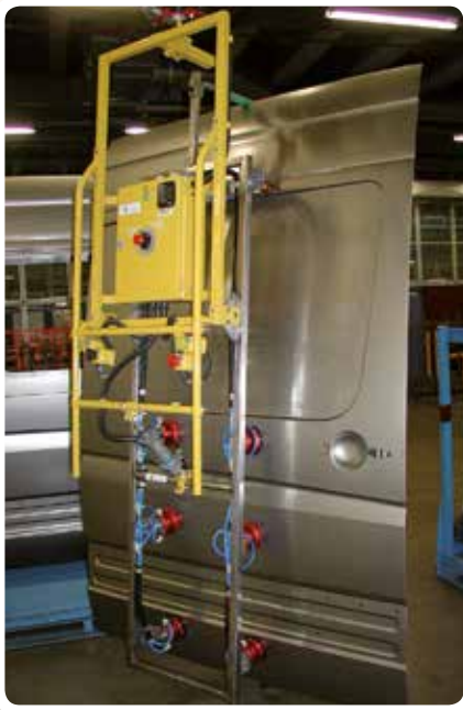
Chwytnak magnetyczny trzyma drzwi samochodu
