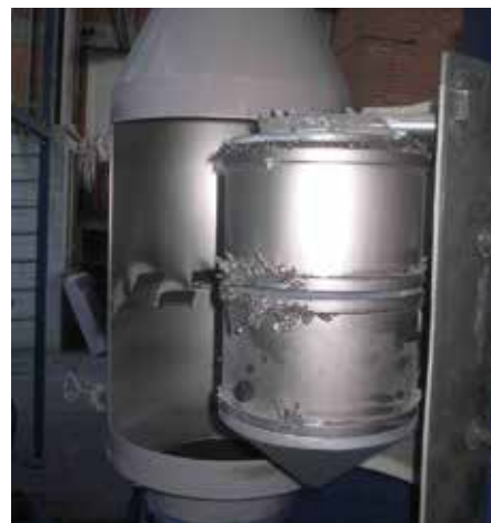
Trubkový magnet pro plastový granulát instalovaný pro vzestupný proud.
