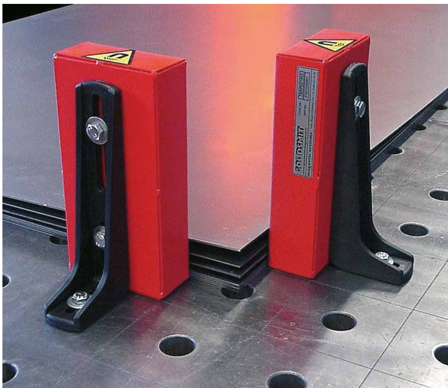
Permanentní, nepřepínatelné čeříče plechů ve feritovém nebo neodymovém provedení; neodym je o 30 % výkonnější a je vhodný pro silně lubrikované plechy v omezeném prostoru.
