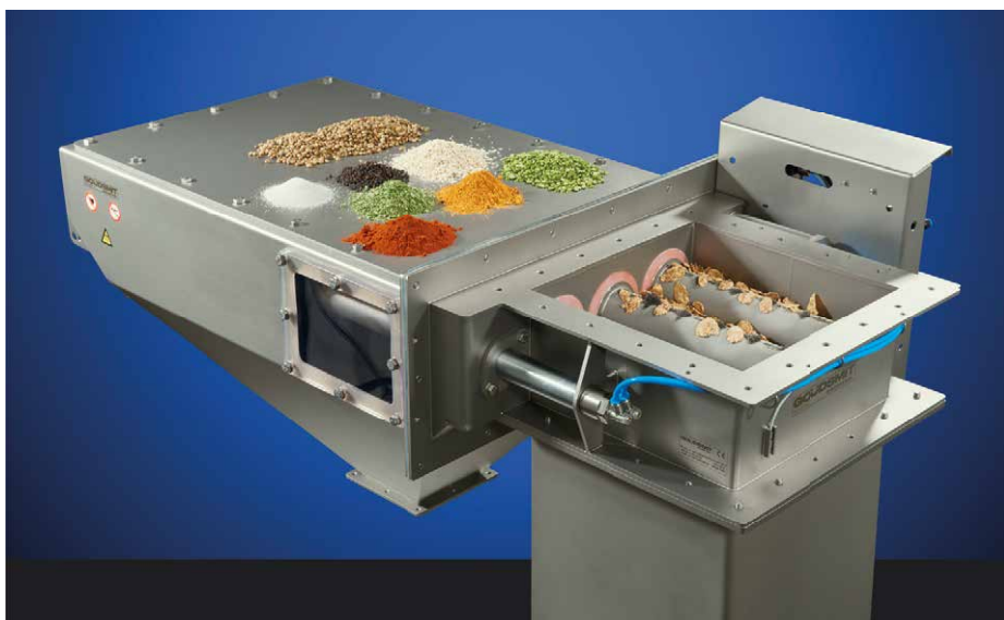
Cleanflow magnet s automatickým čištěním (Easy Clean)
