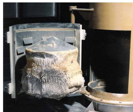
Trubkový magnet pro keramický materiál
