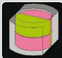
Magnetický vnitřní systém je zkrátován = magnet vypnut.
