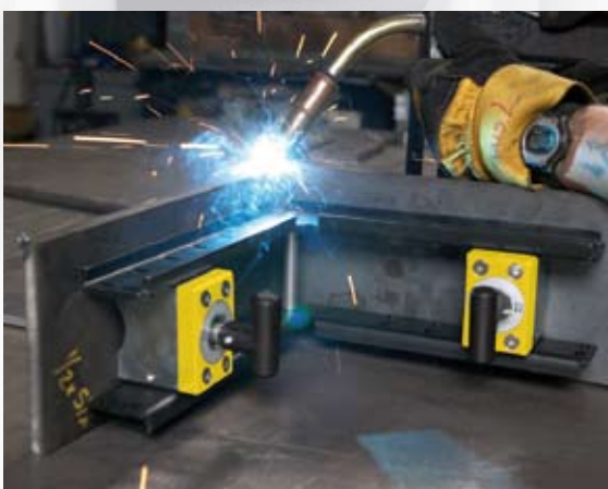
Magnetický vnitřní systém je zkrátován = magnet vypnut.
